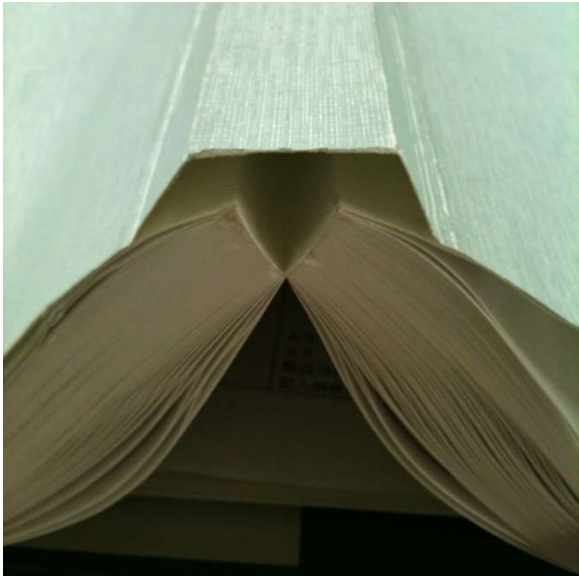
寒冷紗補強くるみ製本
