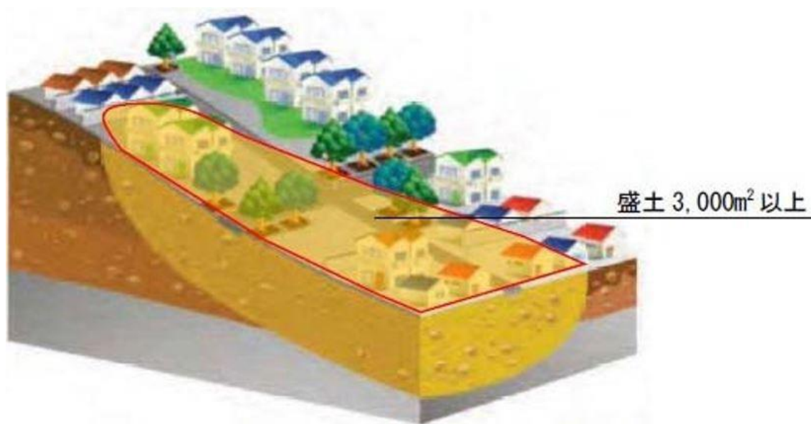
図3-1-7 谷埋め型大規模盛土造成地の例①
