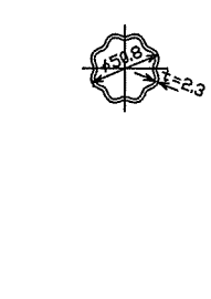
リブ付パイプ断面図 S=1:3
