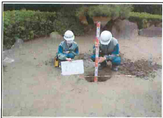
上流部の小規模な池では、噴出土砂(厚23~55cm)で池全体が埋まっていた
