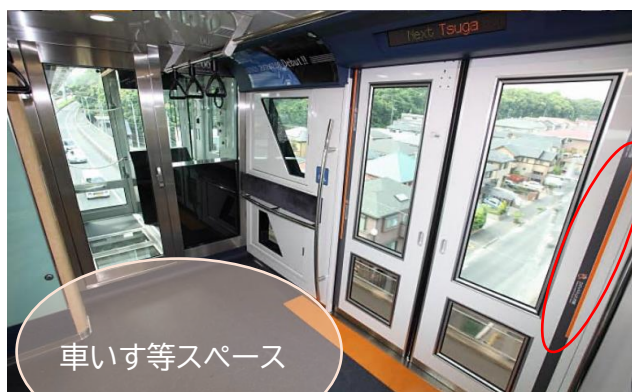
ドアの戸袋付近に引き込み注意喚起ステッカーを貼付
