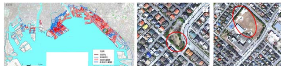
図-4 東京湾岸の液状化発生分布 写真-1 公園・小学校の敷地での噴砂現象 (Google Earthより2011/3/31撮影)
