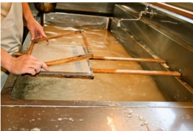
水槽に入れた古紙パルプを漉き型枠に流し込む
