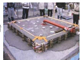
免震下部ベースプレート コンクリート充填試験状況
