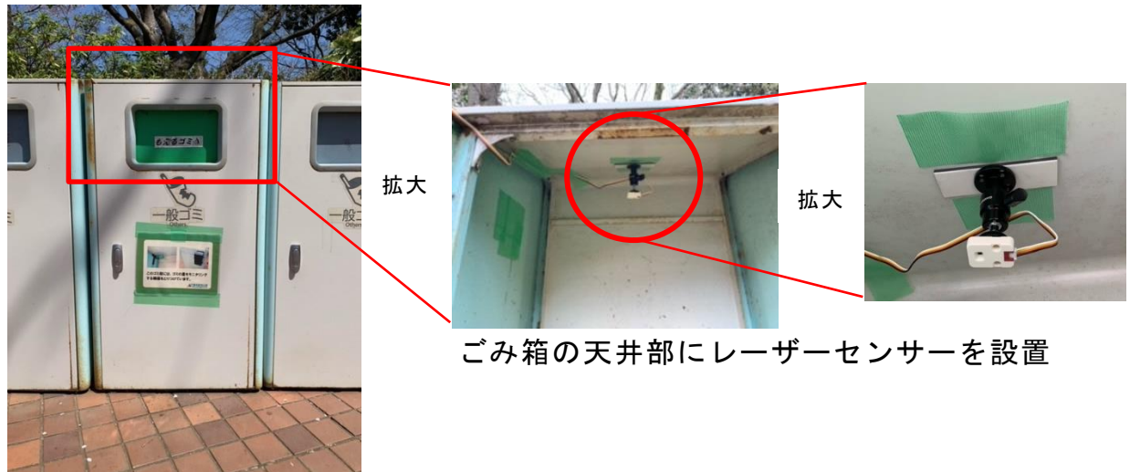
図 1：モニタリングするごみ箱と設置したセンサー
